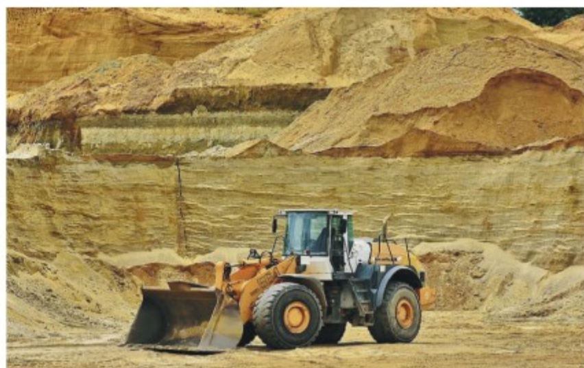
La máquina de Equitesa-Equitransa extrae los sedimentos acumulados en el lugar de la toma de agua para potabilizar y distribuir entre los habitantes de la ciudad de Chone.
